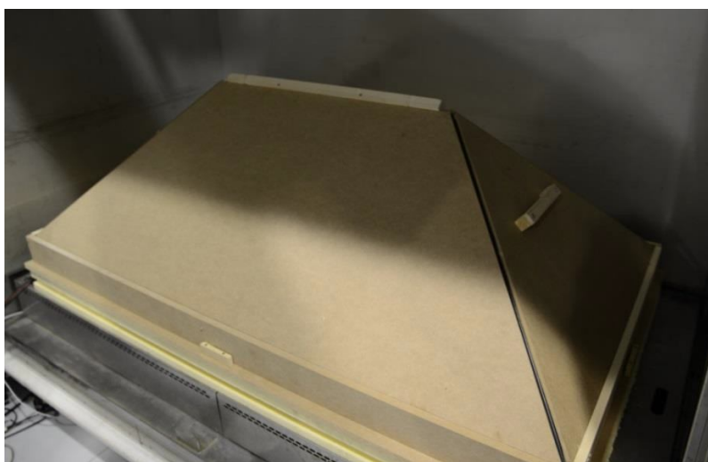
Rysunek 12 - Izolowana konstrukcja pokryta repliką dachu
