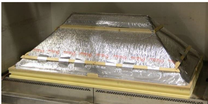
Rysunek 11 - Konstrukcja zaizolowana 1 warstwą materiału Aluthermo Quattro®
