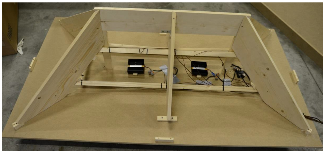
Rysunek 2 - Podstawowa konstrukcja drewniana i system ogrzewania
