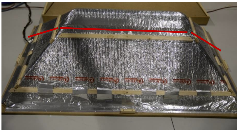
Rysunek 10 - Izolacja z użyciem Aluthermo Quattro®
