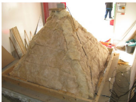
Zdjęcie 1 Wata szklana położona na krokwiach
